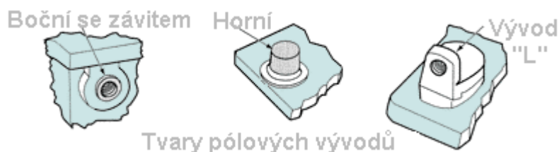
Obrázek 9 Tvary pólových vývodů akumulátoru.
