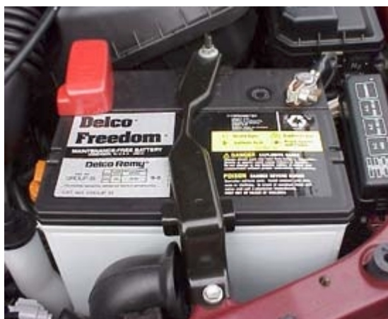
Obrázek 17 Upevnění akumulátoru do vozidla.
