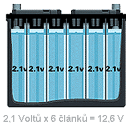
Obrázek 16 Napětí článku a napětí akumulátoru.
