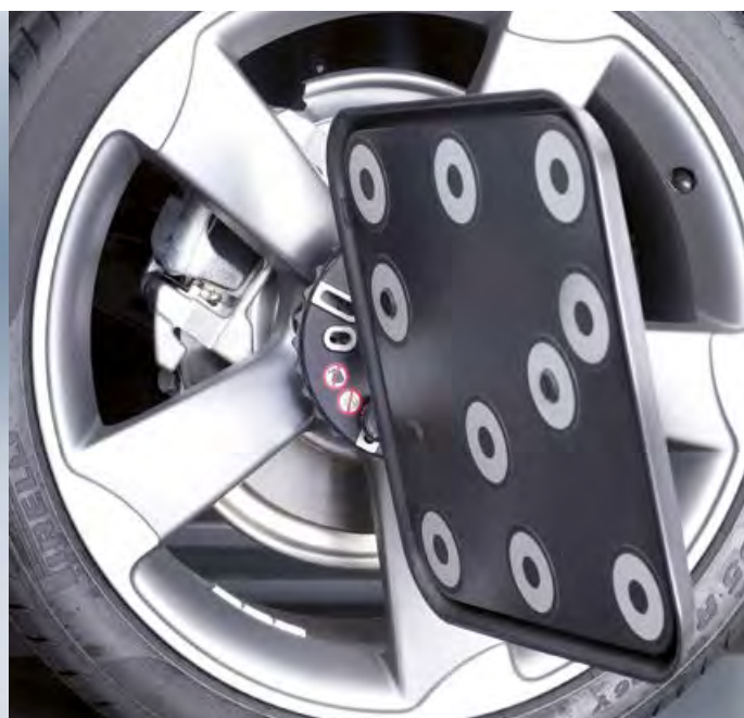
Magnetický držák: Bleskově připojen přímo na šrouby kol
