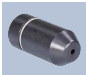
Hlavice / mírný konus / Ø 22,5 mm / délka hlavice 48 mm / celkem 100 mm Obj. č.: 1 695 655 312
