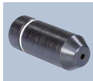
Hlavice / mírný konus / Ø 22,5 mm / délka hlavice 58 mm Obj. č.: 1 695 655 313
